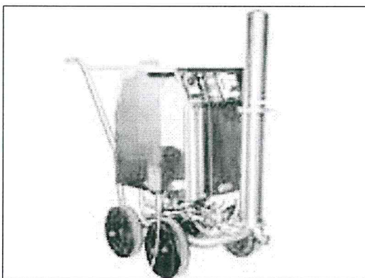
► Generador de ozono para la limpieza de la bodega.
